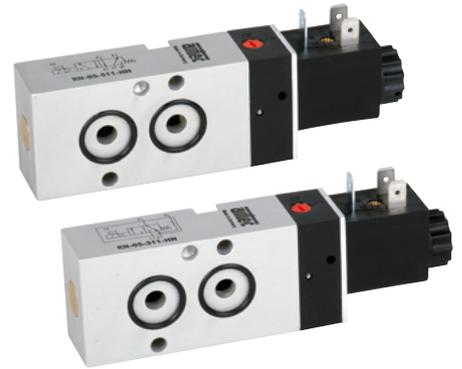
Elektrisch betätigtes Kolbenschieber-Ventil. Nach Zuschalten der Spannung wird das Ventil umgesteuert. Die Ventile sind mit einer rastenden Handhilfsbetätigung ausgestattet. Die Betätigung erfolgt mittels Schraubendreher. Die Version KN-55 ist mit einer feuchtigkeitsbeständigen Magnetspule und einer zusätzlichen Abdichtung am Magnet ausgerüstet. Befestigungsschrauben, Codierstift und O-Ringe gehören zum Lieferumfang.
