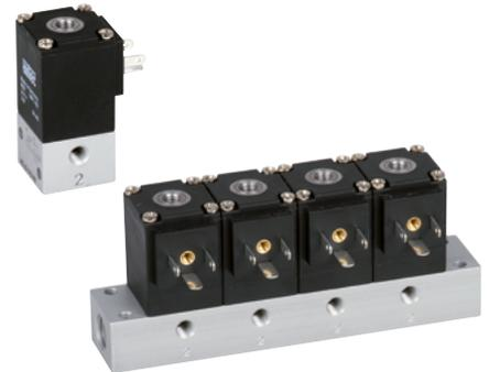
Elektrisch betätigtes Sitzventil. Nach Zuschalten der Spannung wird das Ventil umgesteuert. Die Ventile sind mit einer rastenden Handhilfsbetätigung ausgestattet. Die Betätigung erfolgt mittels Schraubendreher.
