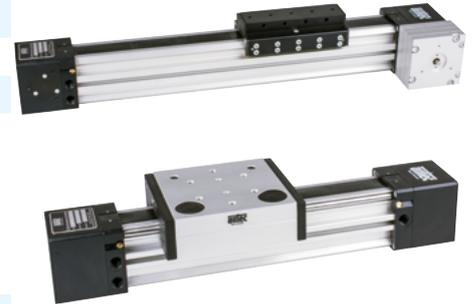
Doppeltwirkender kolbenstangenloser Pneumatikzylinder, beidseitig mit einstellbarer, pneumatischer Endlagendämpfung. In einem geschlossenen Profil wird ein Zahnriemen vom Kolben mitgenommen, der einen Schlitten mit Führung antreibt. Der Kolben läuft gegenläufig zum Schlitten.
